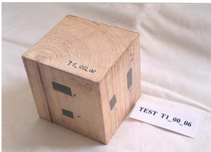
obr. 4.8 Vzorek dřeva zkoušený na tlak ve směru vláken
